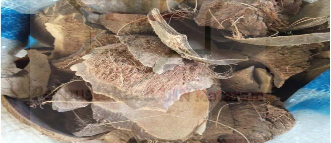
Gambar. Tempurung Kelapa Digunakan Sebagai Bahan Untuk Dalam Pembuatan Briket Bioarang
