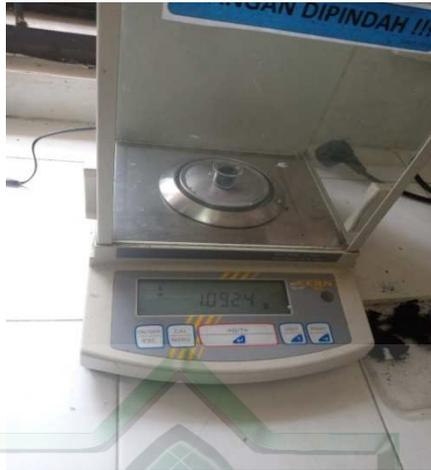
(Penimbangan Bahan Sebelum Dimasukkan Ke Dalam Bom Kalorimeter)
