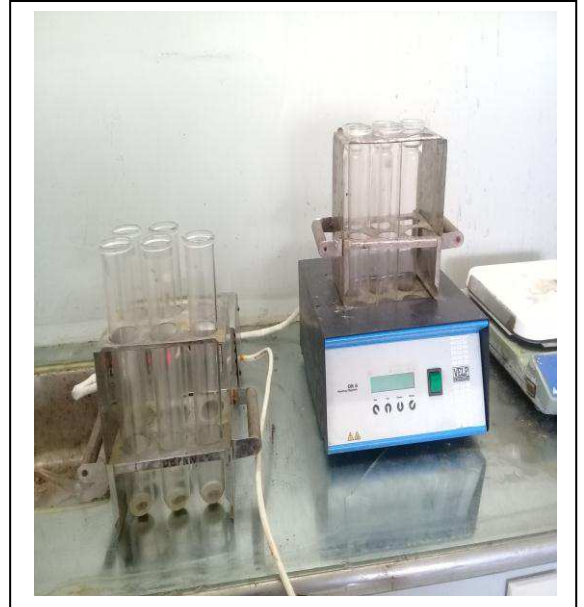
Proses pemanasan sampel sampai berubah warna menjadi jernih
