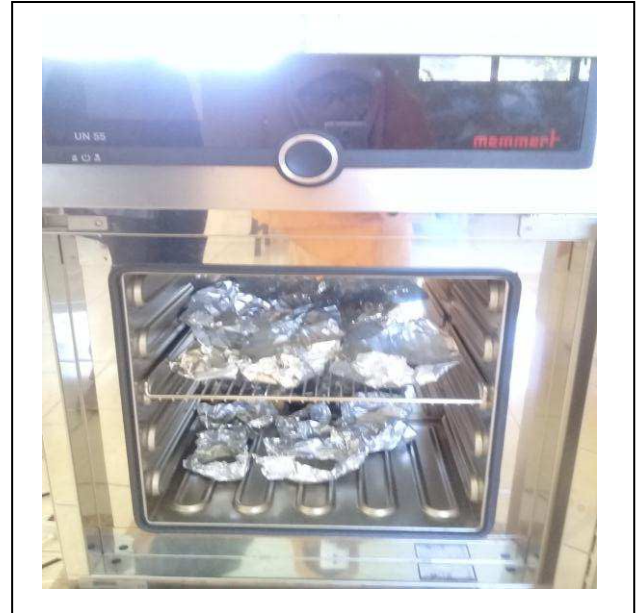
Proses pemanasana sampel kedalam oven dengan suhu 200° C. Dengah waktu 1 jam.
