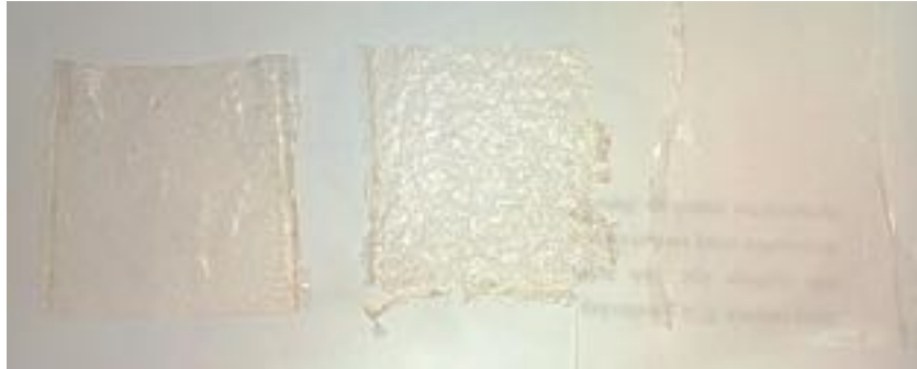
Gambar 4.4 Membran Kitosan Komersil, Kitosan Kulit Udang, dan Kitosan Cangkang Rajungan Dengan Penambahan Litium
