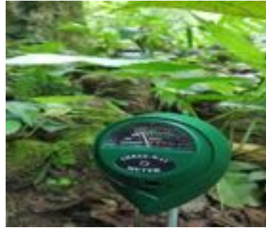
Gambar 0.10. Pengukuran Kelembaban Tanah
