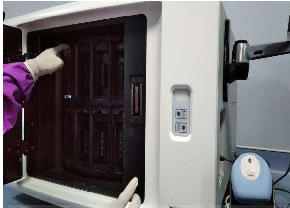
Memasukkan panels kedalam alat identifikasi BD Phonix M50
